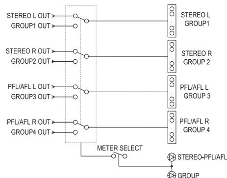
Mithilfe dieser Pegelanzeigen können Sie verschiedene Signalpegel betrachten: die Pegel an den STEREO-OUT-Buchsen L/R, die PFL- und AFL-Pegel, sowie die Pegel an den GROUP OUT-Buchsen 1–4. Die von den Pegelanzeigen dargestellten PFL- und AFL-Signale können Sie über die Buchsen MONITOR OUT und PHONES abhören.
