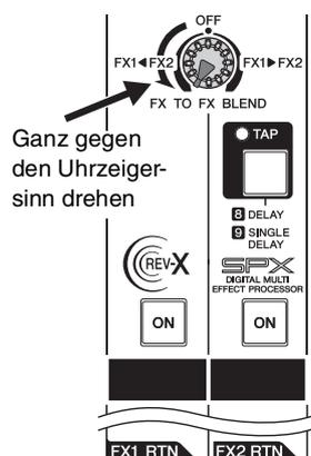
6. Schalten Sie den ON-Schalter am FX1-RTN-Kanal ein, und regeln Sie dann den FX1-RTN-Fader hoch, um den Effektanteil einzustellen.
