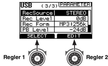
3. Drehen Sie an Regler 1, um „RecSource“ (Aufnahmequelle) auszuwählen, und drehen Sie dann an Regler 2, um einen der Busse „STEREO“ oder „MATRIX1/2“ zu wählen.
