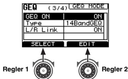
2. Drehen Sie an Regler 1, um „GEQ ON“ auszuwählen, und drehen Sie dann an Regler 2, um „ON“ einzustellen.
