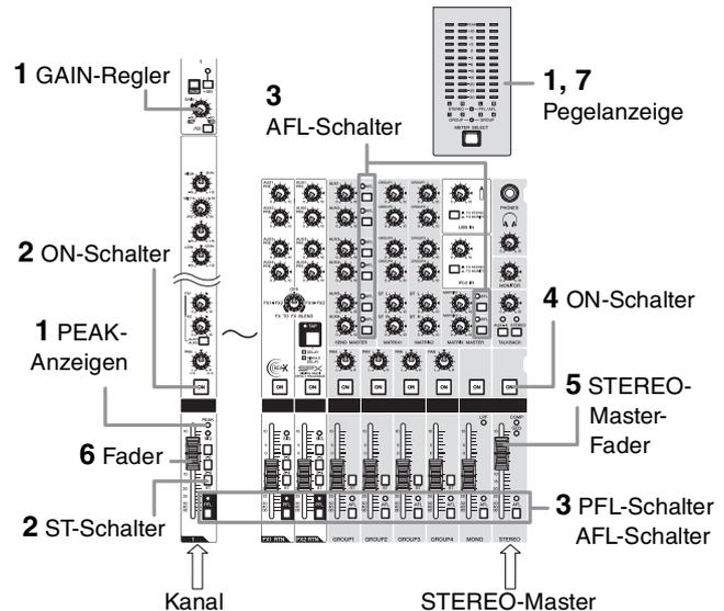
1. Während Sie auf dem Instrument spielen oder in das Mikrofon singen, drehen Sie die GAIN-Regler so weit auf, dass die entsprechenden Spitzenpegelanzeigen bei den höchsten Pegeln kurz rot aufleuchten.
