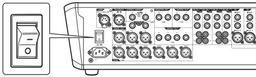
2. Schließen Sie den weiblichen Stecker des beliebigen Netzkabels an der Buchse [AC IN] an.
