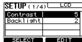
2. Drehen Sie an Regler 1, um „Backlight“ auszuwählen, und drehen Sie dann an Regler 2, um die Helligkeit des Displays einzustellen.
