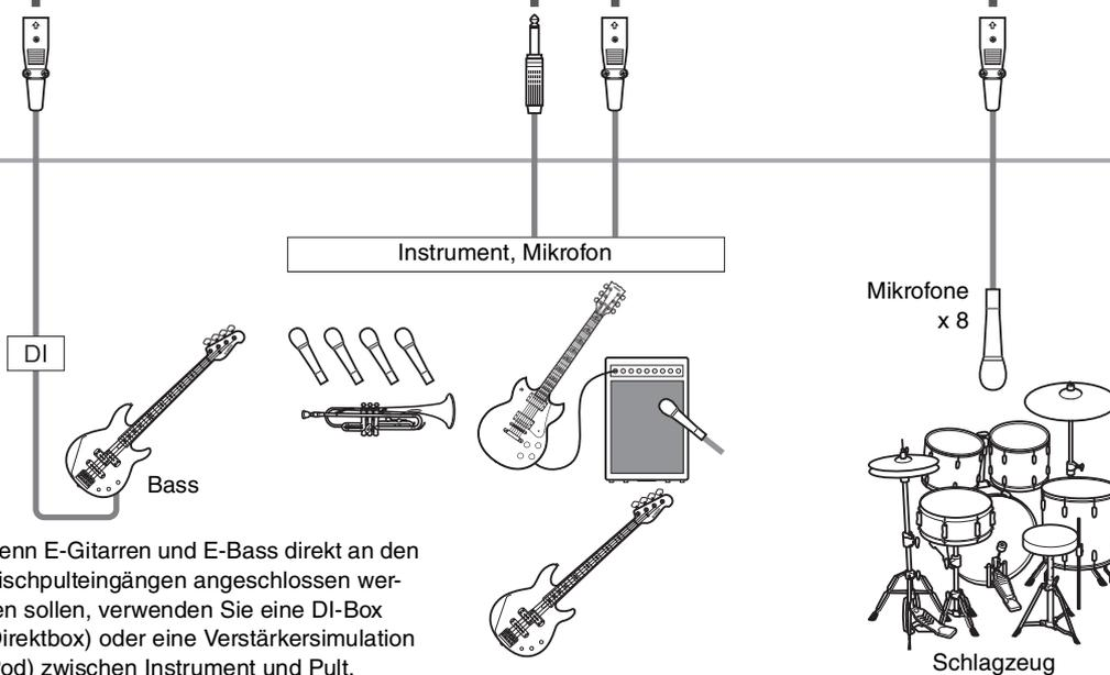
\* Wenn E-Gitarren und E-Bass direkt an den Mischpulteingängen angeschlossen werden sollen, verwenden Sie eine DI-Box (Direktbox) oder eine Verstärkersimulation (Pod) zwischen Instrument und Pult.
