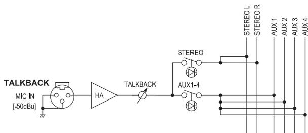
Die Talkback-Funktion verwenden Sie hauptsächlich, um Anweisungen vom Bediener an die Musiker und Studio-/Bühnenpersonal zu übermitteln. In diesem Bereich stellen Sie den Pegel des Mikrofonsignals von der Buchse TALKBACK MIC IN ein, und Sie wählen den Bus für die Ausgabe des Mikrofonsignals.
