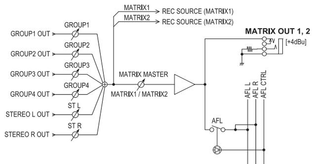
In diesem Bereich können Sie Pegel und Signalausgabe von GROUP OUT und STEREO OUT an die Buchsen MATRIX OUT kontrollieren. Die Signale von den Bussen MATRIX 1 und 2 werden jeweils zu den Buchsen MATRIX 1 und 2 gesendet.
