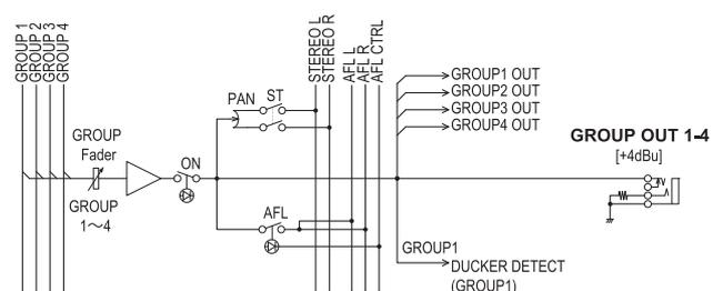
In diesem Bereich können Sie Pegel und Signalwege der vier GROUP-Busse kontrollieren. Während das Signal der einzelnen GROUP-Busse immer an die jeweils entsprechende GROUP-OUT-Buchse geführt wird, können Sie mithilfe der Schalter ST und AFL diese Gruppensignale zu den Bussen STEREO und AFL senden.
