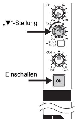
5. Drehen Sie den Regler FX TO FX BLEND gegen den Uhrzeigersinn bis zum Anschlag.
