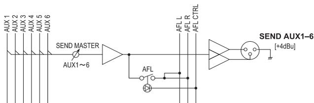
In diesem Bereich können Sie Pegel und Signalwege der sechs AUX-Busse kontrollieren. Jedes dieser Signale wird an der entsprechenden SEND-Buchse (AUX1–AUX6) ausgegeben.
