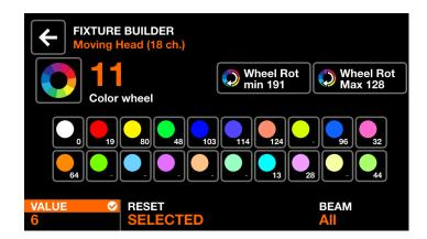
Wenn du den zweiten Encoder drückst, wird die Farbe zurückgesetzt. Wenn du ein Gerät mit mehr als einem Beam hast, wähle den verknüpften Beam mit dem vierten Encoder.
